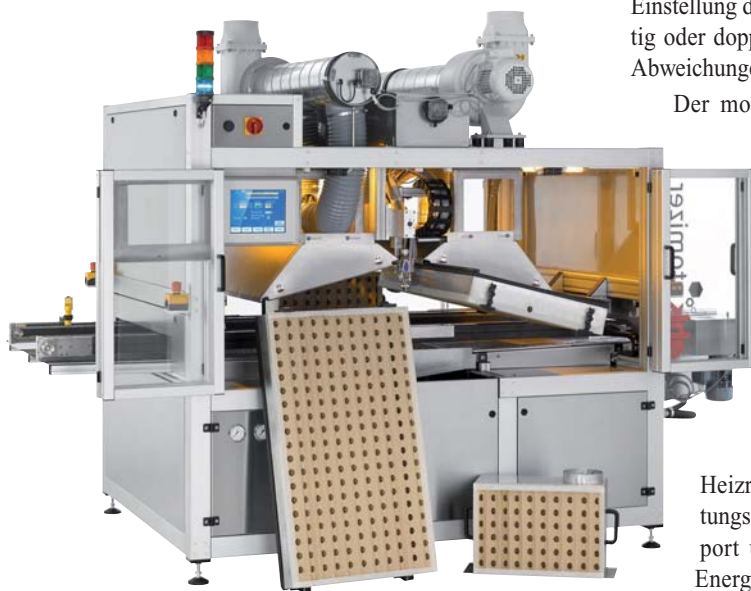
Die Sprühanlage ‚atomizer‘ ist hier im Wartungsmodus zu sehen
