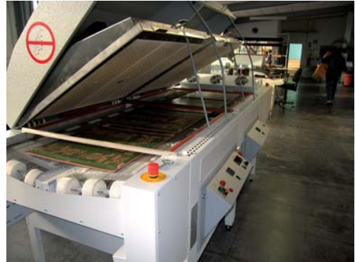
Außenhaube und Heizraumoberteil offen
