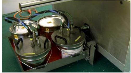
Hier ist die Sprühanlage doppelseitig mit zwei Lackbehältern versehen mit Abdeckungen für Lackumlauf zur Versorgung der zwei Sprüheinheiten
