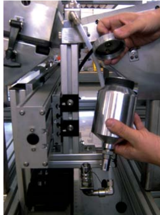
Lackwechsel per Kartusche oben (Bild links) und unten an der Sprühanlage (die drei Bilder zeigen den Ablauf: Luftdruck aus, Deckel auf und Kartuschenwechsel, Deckel zu und Luftdruck an)
