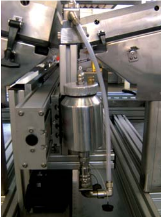
Lackwechsel per Kartusche oben (Bild links) und unten an der Sprühanlage (die drei Bilder zeigen den Ablauf: Luftdruck aus, Deckel auf und Kartuschenwechsel, Deckel zu und Luftdruck an)
