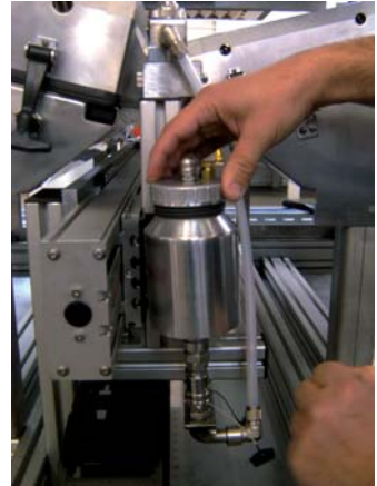
Lackwechsel per Kartusche oben (Bild links) und unten an der Sprühanlage (die drei Bilder zeigen den Ablauf: Luftdruck aus, Deckel auf und Kartuschenwechsel, Deckel zu und Luftdruck an)
